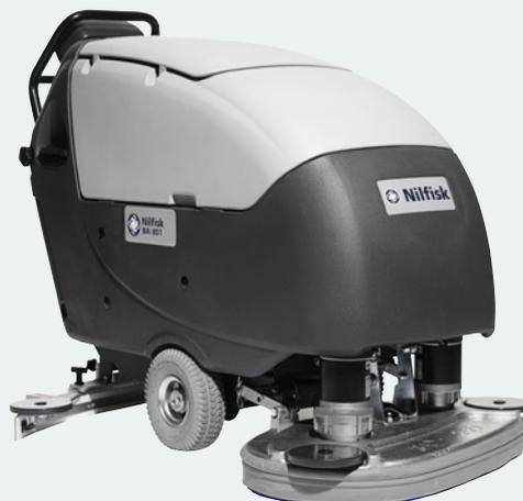
← Бак для грязной воды наклоняется, чтобы обеспечить доступ к аккумуляторной батарее или баку для моющего средства без необходимости опустошать бак для раствора
